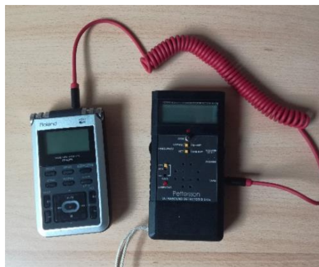
Photo 1 - Détecteur ultrasons Petterson D240x (Petterson Elektronik) et enregistreur Roland-R05 (Roland) Source : Photo Althis
