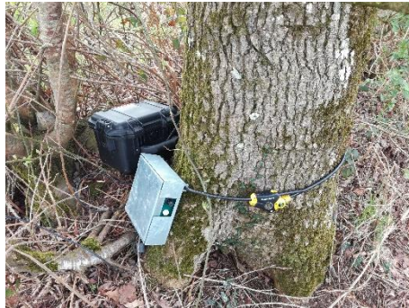
Photo 3 - Enregistreur d'ultrasons de type SM2bat+ (Wildlife Acoustics)
