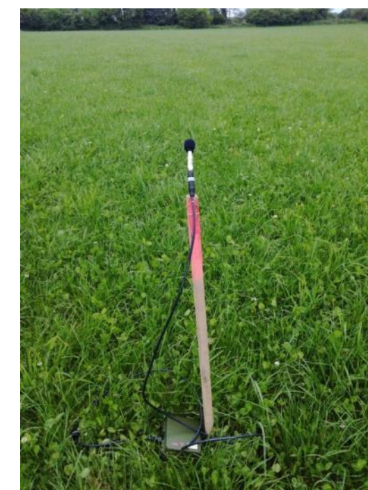
Photo 2 - Enregistreur d'ultrasons de type SM4bat (Wildlife Acoustics)
